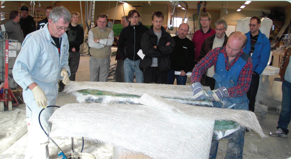
Inge Sandström från Sandström Innovation (t.h.) vid tillverkning av ett verktyg för utvärdering av Reichholds formbyggnadsmaterial.
